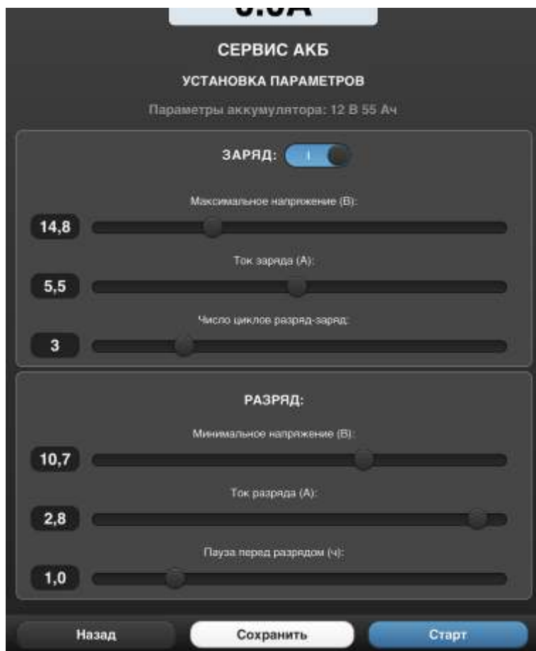
Рис. 18 - Установка параметров заряда и разряда
